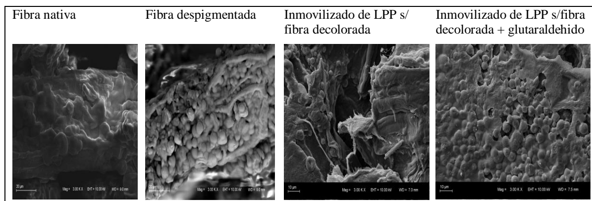
Figura 1: Microscopia electrónica de barrido (MEB) para las formas de fibra nativa, despigmentada y de los derivados inmovilizados
